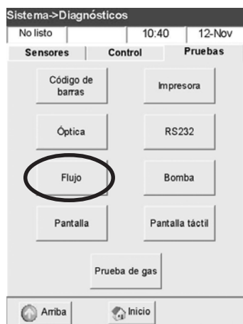
Fig. 7-23 Prueba flujo de la bomba
