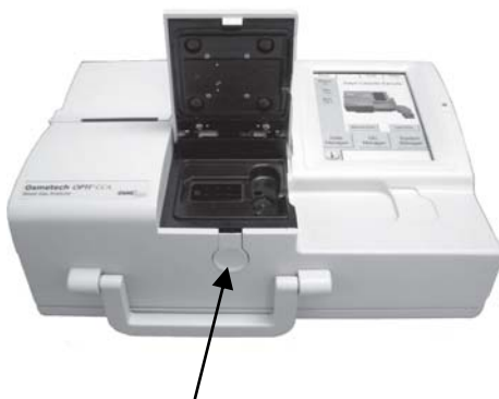
Fig. 1-4 Apertura de la tapa del SMC
