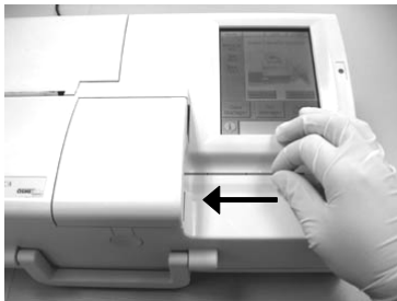
Fig. 5-9 Colocación de una muestra con capilar
