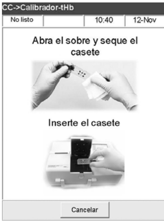
Fig. 6-8 Insertar el Calibrador
