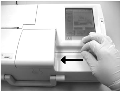
Fig. 4-23 Colocación de un tubo capilar
