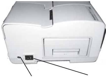
Fig. 1-14 Conector de alimentación e Interruptor de Encendido/Apagado
