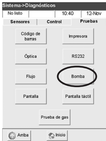
Fig. 7-28 Prueba del motor de la bomba
