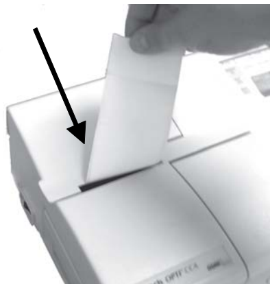
Fig. 6-29 Eliminación del exceso de papel
