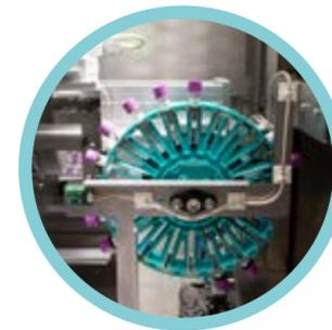
Ciclo de homogeneización automática con inversión completa del tubo
